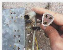
**Klassische Verbindungen: Links der Antennenanschluss, rechts die Lautsprecherbuchsen.**
