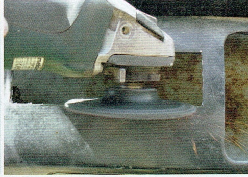
Leider manchmal nötig: Aufweiten des Schachts (hier beim VW T2). Alte Radios messen meist 170 x 40 mm
