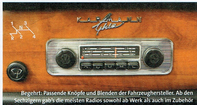
Wenn das Außenmaß des Radios passt, sollte man sich sicher sein, dass der Einbauschacht im Fahrzeug auch tief genug ist – manche Autos bieten wenig Platz!
