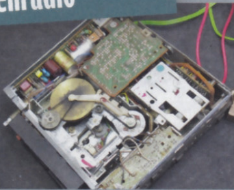
2 Das Kassettenteil wird gereinigt, danach werden Antriebsriemen und Andruckrolle getauscht
