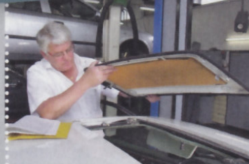
2 Das Schiebedach ist mit acht Schrauben befestigt. Danach beginnt die eigentliche Arbeit
