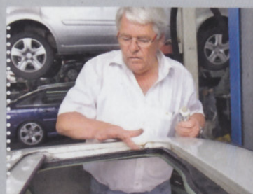
11 Die Abdeckung des Führungsseils bekommt etwas Fett, damit die Mitnehmer besser gleiten
