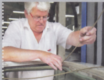
6 Die beiden neuen Führungsseile werden einfach in die jeweilige Nut gelegt – ohne Fett und Öl
