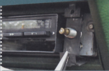
1 Die Befestigungsklammern sitzen sehr stramm und lassen sich nur mit der Zange lösen
