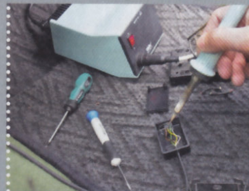
9 Der Adapter lässt sich so nicht durchstecken, also wird er abgekiffen und wieder angelötet
