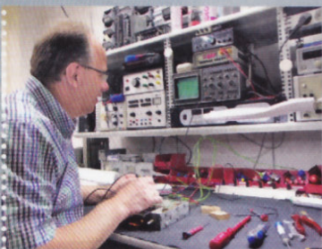
3 Die Messgeräte bringen schnell Gewissheit: Das Radio hat kein Hochfrequenzsignal
