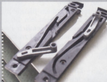
5 Gut zu erkennen: In der linken Kulisse fehlt ein Stück und verhindert so das Heben und Öffnen
