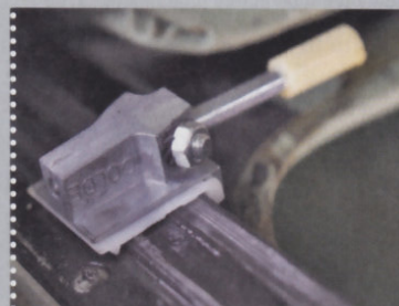
7 Mitnehmer am Ende der Führungsseile übertragen die Kraft von der Kurbel aufs Schiebedach
