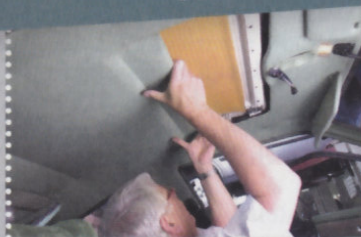
1 Um an die Schrauben des Schiebedachs zu kommen, muss der angeknöpfte Himmel gelöst werden
