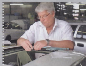
8 Präzisionsarbeit: Die Mitnehmer müssen genau 342 Millimeter hinter der vorderen Kante sitzen
