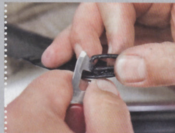
3 Der Windabweiser hakt, weil die Aufnahme für den Niederhalter gebrochen ist. Noch gibt es Ersatz
